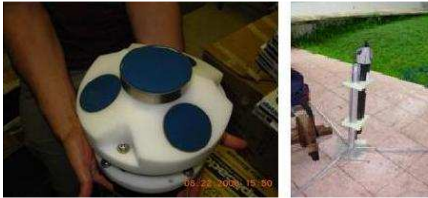
Figura 4.1: Corrientímetro Nortek Aquadopp Profiler.
